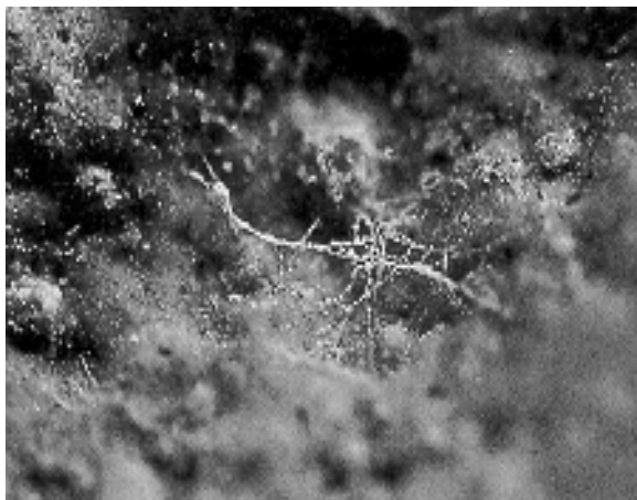
Abb. 3: Schimmelpilz an Betonoberfläche (links) sowie isoliert (rechts), aus /3/
